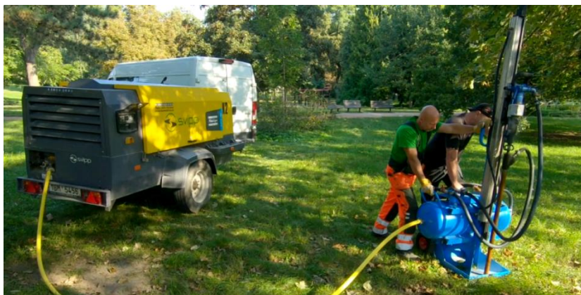
Obrázek 2.5 Prototyp přístroje pro hlubkové provzdušňování, park Lužánky Brno
