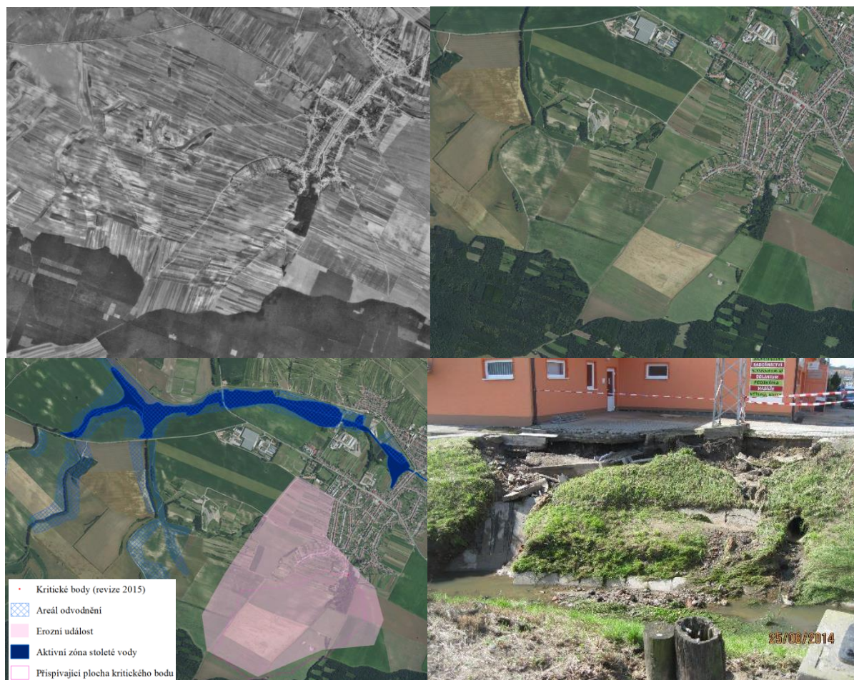
Obrázek 9: Vlevo nahoře letecký snímek z 50. let, vpravo nahoře aktuální letecký snímek, vlevo dole znázornění vstupujících limitů, vpravo dole fotografie poškození v intravilánu při zaznamenané erozní události (VUMOP, v.v.i).
