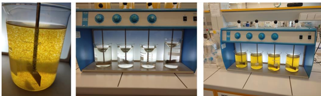
Obrázok 2: Proces koagulácie a stav vzorky pred a po pridaní koagulačného činidla.
