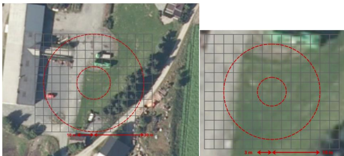
Obr. 3): Letecké snímky blízkeho okolia stanice Huggenes. Štrkové parkovisko je blízko k stanici a funguje ako zdroj tepla. Výsledkom je trieda 4 vzhľadom na zdroj tepla.
