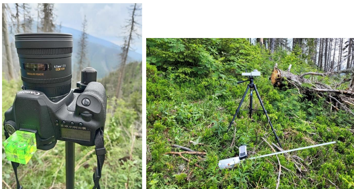
Obrázok 2: Fotoaparát Canon EOS 50D (vľavo) a prístroj SunScan (vpravo)
