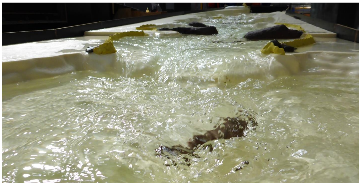
Obr. 3 Fyzikální model po úpravách s průtokem 10 l/sec
