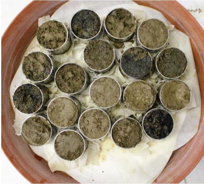
Obr. 2 Neporušené pôdne vzorky a stanovovanie retenčných kriviek
