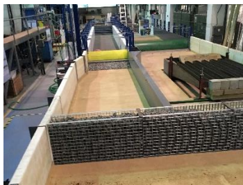
Obr. 4 Nadjezí včetně uklidňovací stěny a přepadových žlábků
