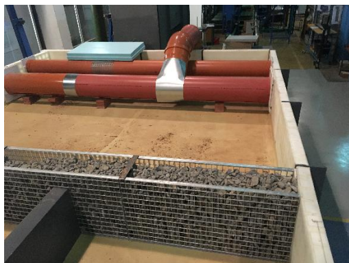
Obr. 11 Přívod vody do modelu a gabion
