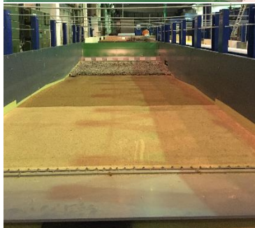
Obr. 7 Podjezí s pohyblivým dnem
