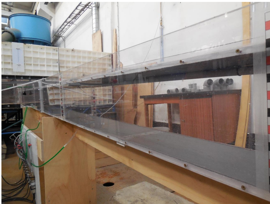
Obrázek 4 - pohled do odpadní chodby proti směru proudění bez chodníčku, s upraveným potrubím pro závlahy (v pozadí je uklidňující nádrž)
