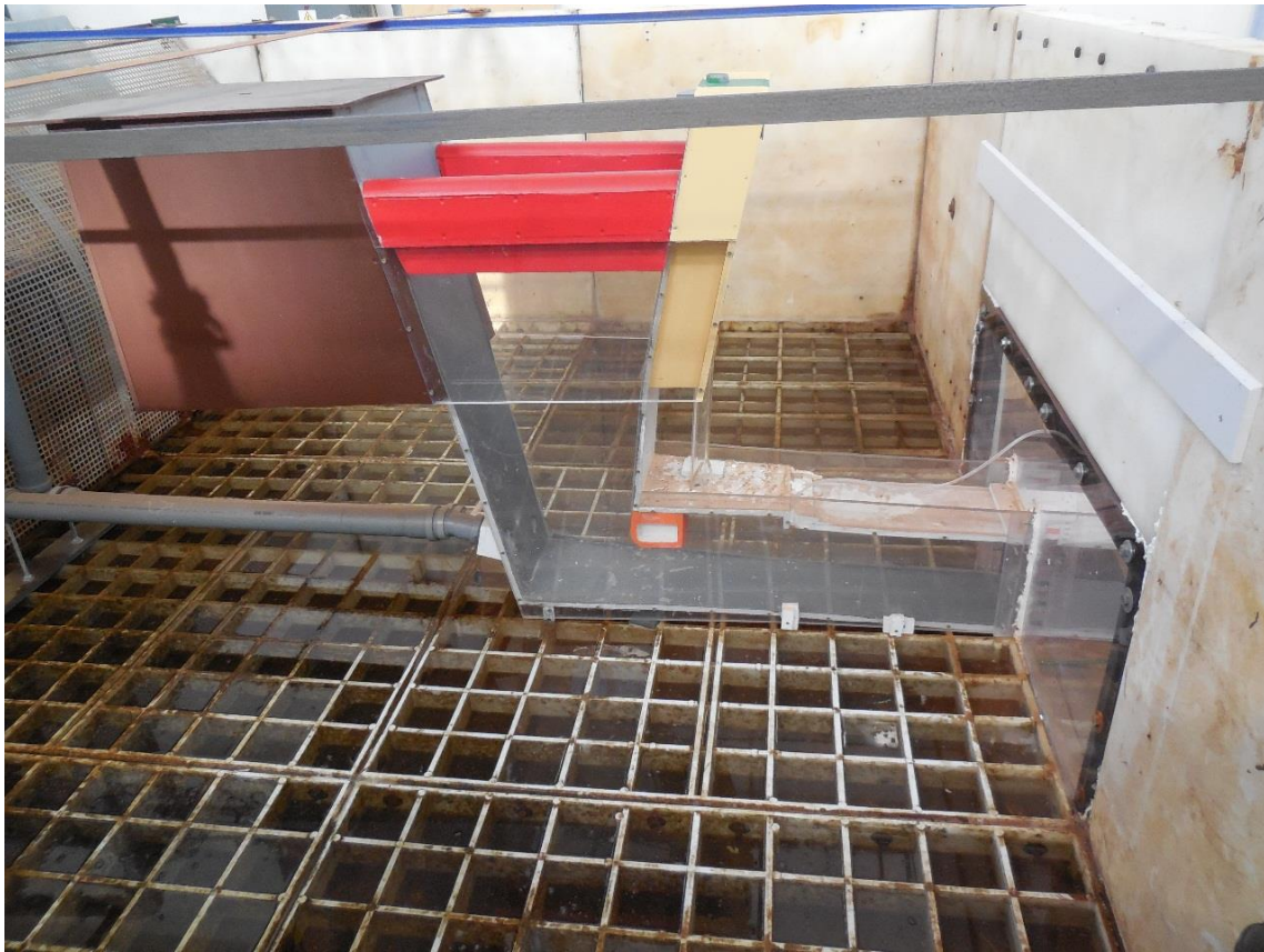
Obrázek 3 - pohled do uklidňovací nádrže na přeliv (výškově jednotný), spadiště a začátek odpadní chodby
