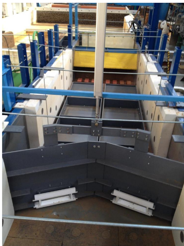
Obr. 2 Vzpěrná vrata s pohybovacím mechanismem na modelu
