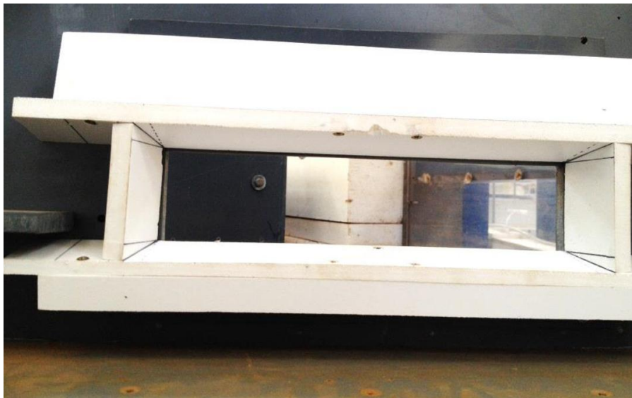
Obr. 6: Detail úpravy plnicích otvorů s horizontálním a vertikálním rozšířením na fyzikálním modelu.
