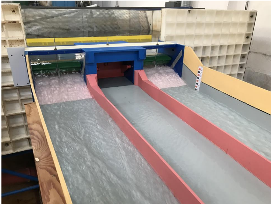
Obrázek 1: Měření konzumní křivky klapkových uzávěrů na fyzikálním modelu VD Nechranice
