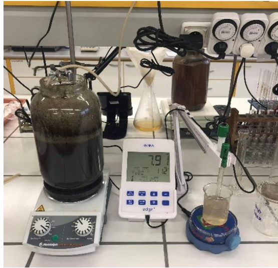
Obrázok 1: Laboratórny model SBR aktivácie
