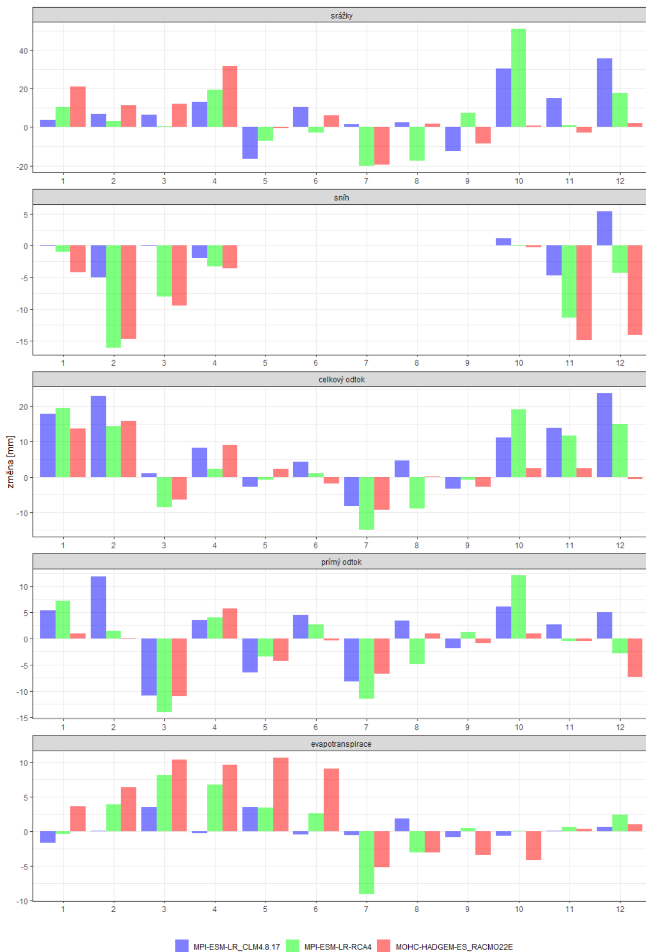
Obrázek 5: Simulace dopadu projekcí změny klimatu pro vybrané složky vodní bilance při scénáři rep 4.5
