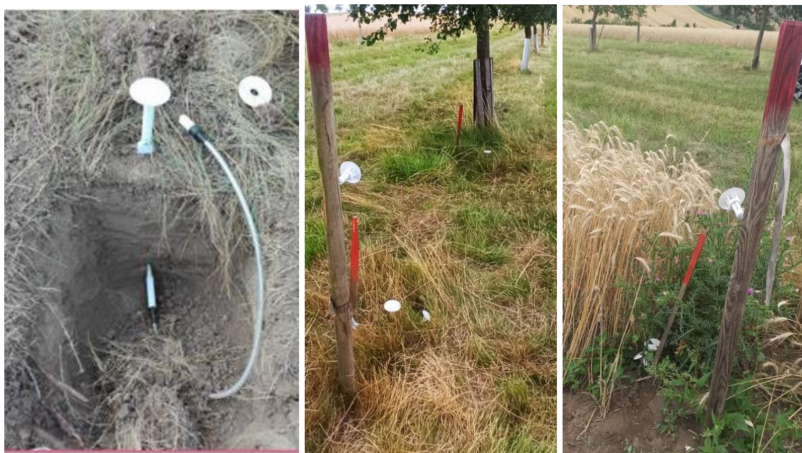
Obrázek 5.2 Vlhkostí čidla; umístování čidla (vlevo), čidla mezi stromy a u stromu (uprostřed), čidla na kraji pole (vpravo)
